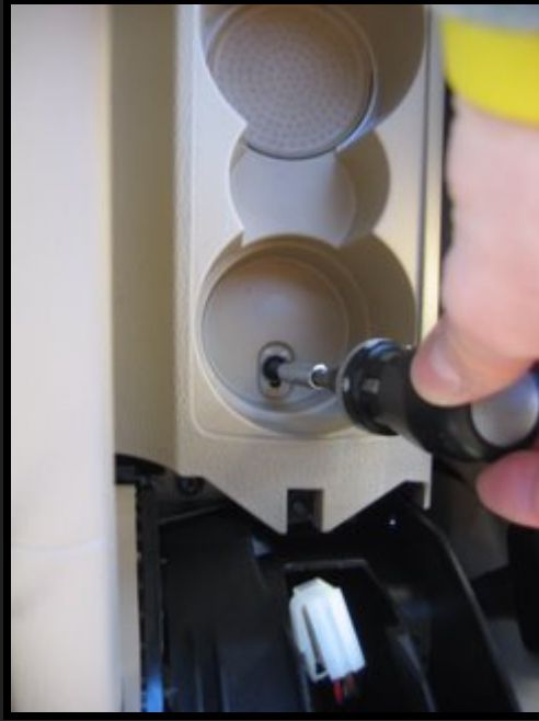
Tylna śruba mocująca konsolę. / The console's rear screw.
