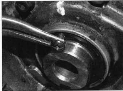
Рис. 9.2,б. ...потянув за саморезы, удалите сальник
