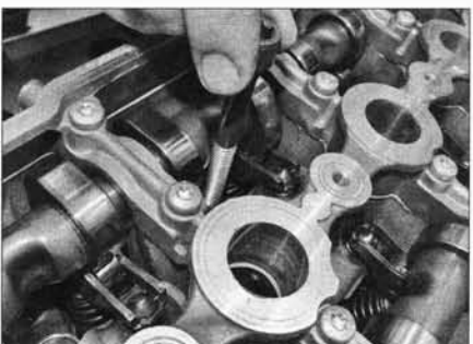
Рис. 10.17. Выверните болты крепления головки
