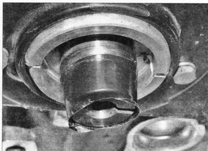
Рис. 8.4. Оберните носок распредвала изолейтой, чтобы не повредить сальник при установке
