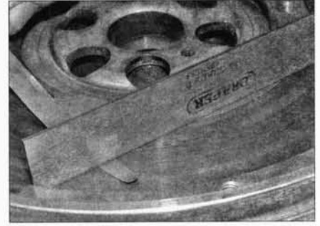
Рис. 13.10,а. Проверка коробления двухмассового маховика
