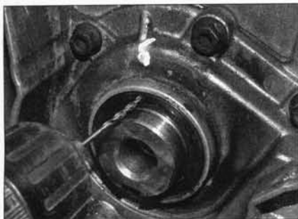
Рис. 9.2,а. Просверлите отверстия в сальнике и заверните в них саморезы...
