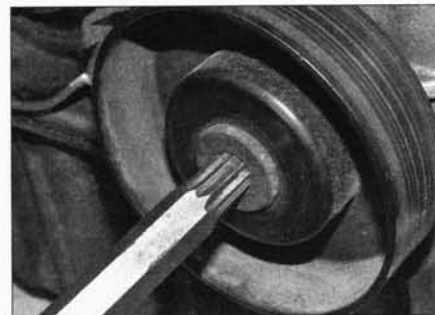
Рис. 9.2,в. Снятие паразитного ролика ремня привода вспомогательных агрегатов
