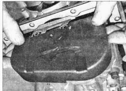
Рис. 15.4,б. ...и снимите крышку цепи
