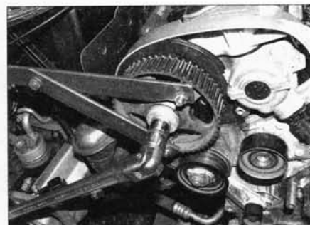
Рис. 5.4,а. Отворачивание болта крепления звездочки распредвала
