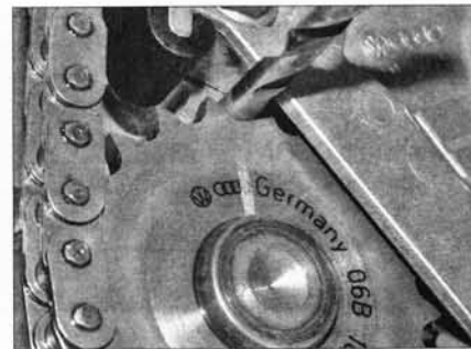
Рис. 15.20. Фиксация звездочки балансирующего вала в ВМТ
