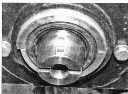
Рис. 8.5. Новый сальник распредвала установлен
